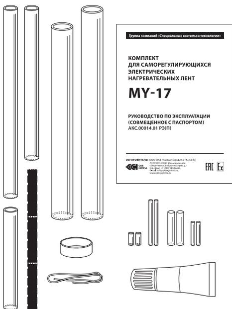
Комплект MY-17 предназначен для соединения высокотемпературных саморегулирующихся электрических нагревательных лент марок VC (свыше 125 °С) с оболочкой из фторопласта с максимальной температурой воздействия 190 °С. Комплект MY-17 включает в себя термоусаживаемые трубки на основе фторполимера, припой, медную луженую плетенку, фторопластовую ленту и клей-герметик.
