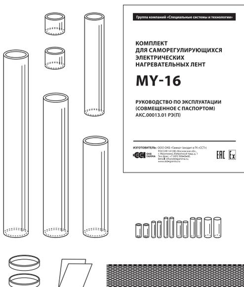
Комплект MY-16 предназначен для соединения саморегулирующихся электрических нагревательных лент марок VM, VL, VR (до 125 °С) с оболочкой из термопластичного эластомера и фторопласта. Максимальная температура воздействия 125 °С.
